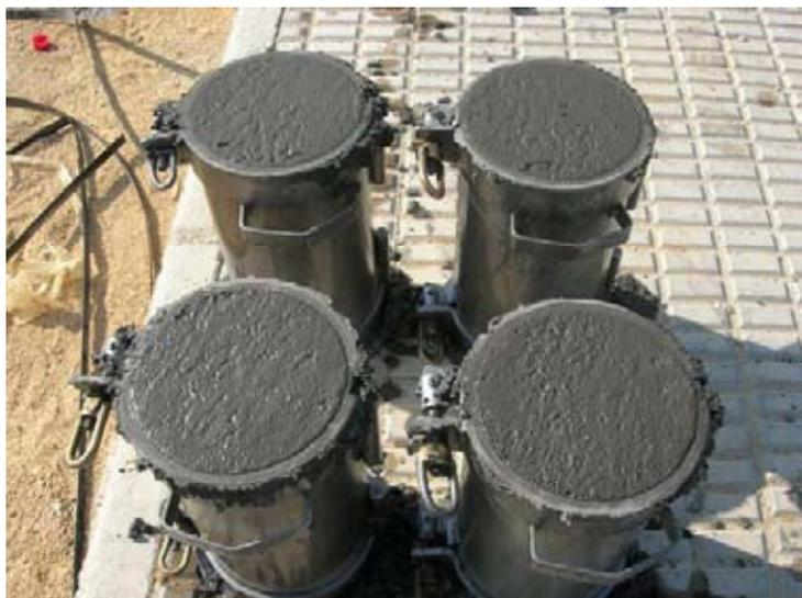
Probetas ejecutadas en obra.
