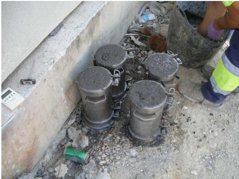
Probetas ejecutadas en obra.
